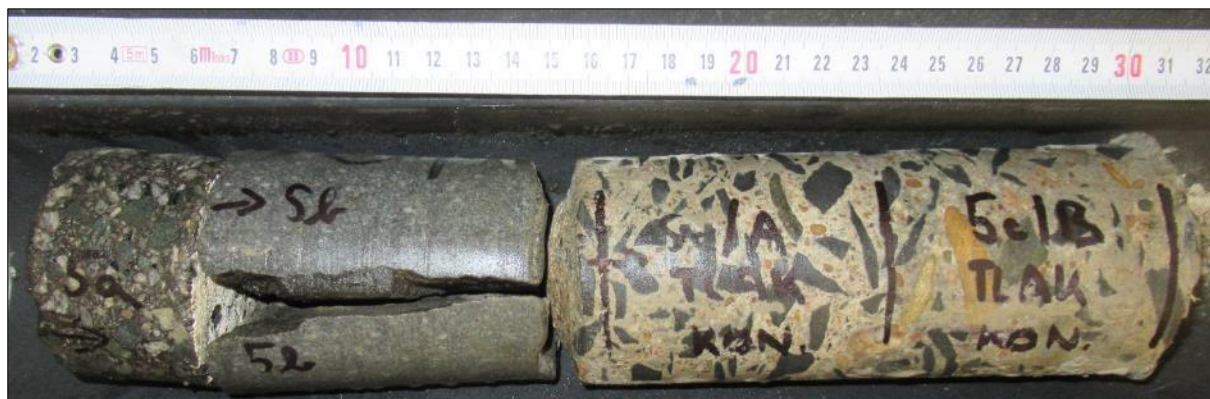
Foto 6: Výnos vrtu č. 5, svislý vrt skrz nosnou konstrukci
